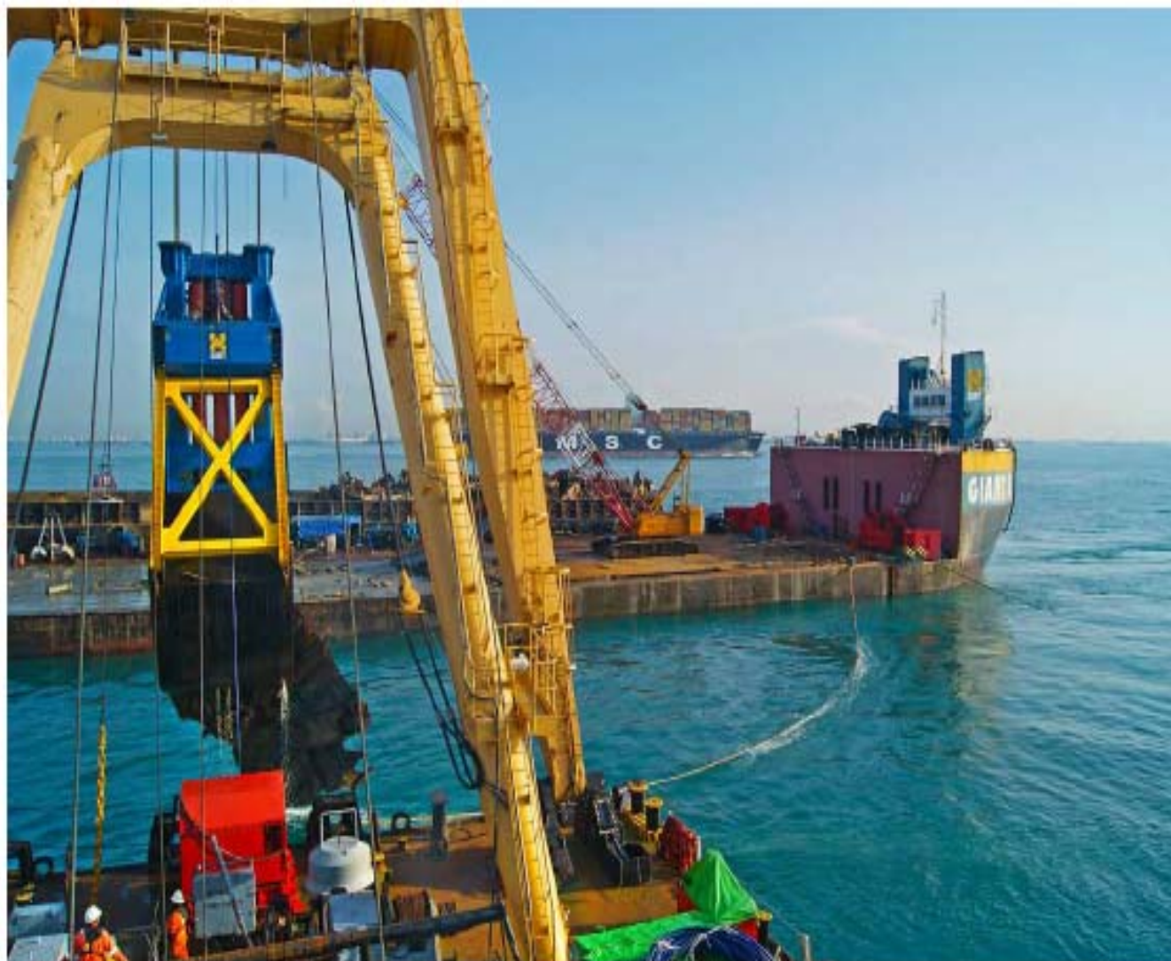
Баржа-кран «Smit Borneo» в процессе удаления контейнеров с севшего на мель судна.
